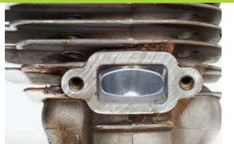
PORT D'ÉCHAPPEMENT D'UNE TRONÇONNEUSE APRÈS 355 HEURES.
